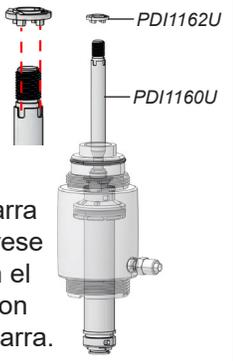
12. Atornille la barra (PDI1160U) al pistón (PCDI034). Atornille el cilindro (PDI1159U) a la tuerca (PDI841) y asegúrese que el puerto de inyección lateral, quede ubicado debajo del puerto de salida en el cuerpo de la unidad. Atornille la campana (MPDI186) al cuerpo de la unidad.
