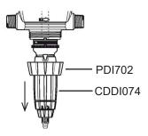
5. Desatornille la tuerca de seguridad (PDI733) del montaje de inyección (CDDI074) y remueva el anillo "C" (PDI727).
