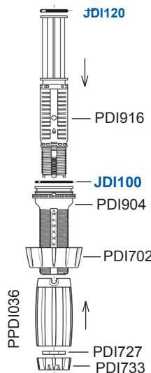
**! Para remover fácilmente el anillo sin uso de herramientas, solo oprimalo en ambos lados y este levantara una parte para ser extraido.**
