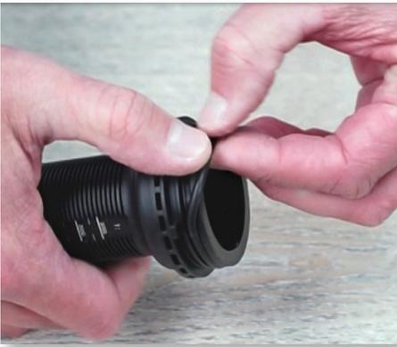
**Paso 10:** Remueva el o-ring (Parte #: JDI100) de la manga de inyección, apretándolo y deslizándolo sobre la manga. Instale el nuevo o-ring en la ranura.
