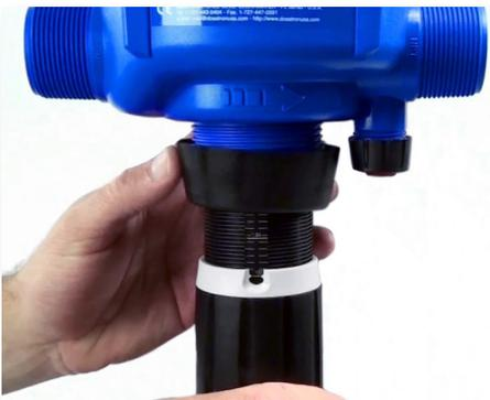
**Paso 2:** Desatornille la tuerca del vástago de inyección y remuévala.
