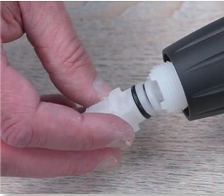
**Paso 18:** Instale la nueva válvula cheque (Parte #: PJDI140) en el vástago como, y atornille la tuerca de la válvula cheque.
