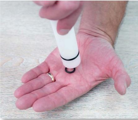
**Paso 12:** Voltee la barra hacia abajo para que el o-ring de la tapa salga de la barra. Deséchelo y reemplácelo con el nuevo o-ring (Parte #: 20J006). Vuelva a atornillar la tapa superior.
