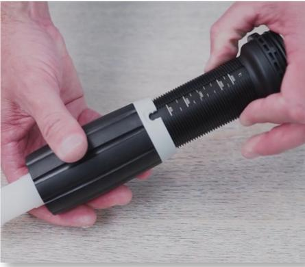
**Paso 15:** Atornille la tuerca de ajuste de nuevo a la manga negra y acomódela en 0.1% or 1:1000. Esto le proporcionara suficiente rosca para el paso siguiente.
