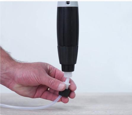
**Paso 26:** Inserte la manguera en la lengüeta y apriete la tuerca. Dele un pequeño jalón a la manguera para asegurarse que está conectada correctamente.
