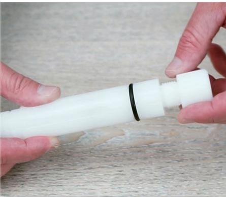
**Paso 11:** Sujete la barra de inyección blanca, y desatornille la tapa superior hasta removerla.
