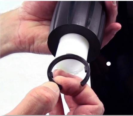
**Paso 7:** Remueva la abrazadera en forma de "C" ensanchando la abertura y deslizándola sobre la barra blanca.
