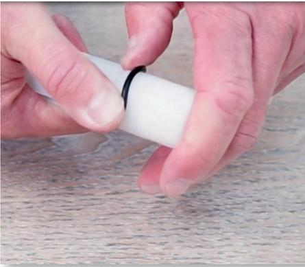
**Paso 13:** Remueva el o-ring de la barra blanca de inyección apretándolo y deslizándolo fuera de la barra. Instale el nuevo o-ring (Parte #: JDI120) en la ranura.
