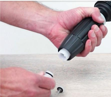
**Paso 5:** Sujete la lengüeta blanca y jale la válvula cheque hasta removerla. Normalmente la válvula cheque sale en dos partes, usted puede desechar estas partes.
