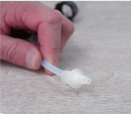
**Paso 25:** Antes de instalar la manguera de succión, deslice el casquillo hacia atrás y corte media pulgada de la punta de la manguera. Vuelva a colocar el casquillo en la punta.
