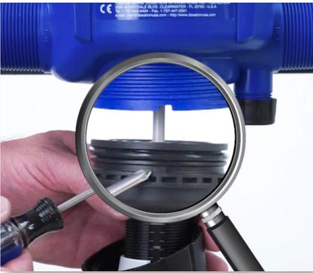
**Paso 24:** Alinee las muescas en la parte inferior del cuerpo azul con los dos dientes en la parte superior del vástago de inyección. Empuje las partes juntas, y apriete la tuerca del vástago de inyección con la mano. Coloque la unidad a un lado.
