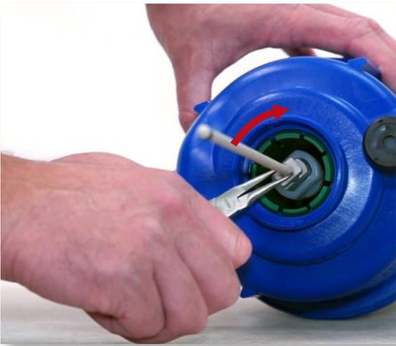
**Paso 22:** Para instalar el nuevo émbolo (Parte #: 8PJ074), use el alicate para alinear la parte superior del émbolo con el retenedor. dele un cuarto de vuelta en la dirección de las manecillas del reloj hasta que ajuste.
