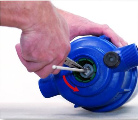
**Paso 21:** Sujete el émbolo por la parte superior con el alicate y girelo cuidadosamente un cuarto de vuelta, en la dirección opuesta a las manecillas del reloj hasta sacarlo, deseche-lo.
