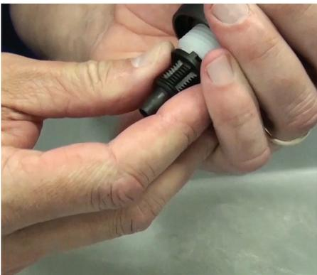
**Paso 5:** Agarre la lengüeta y jale la válvula cheque completamente hacia afuera.
