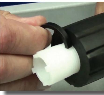
**Paso 15:** Reinstale la arandela en forma de "C" deslizándola sobre las roscas en la parte inferior de la barra blanca. Dele vuelta a la arandela hasta que encaje en su lugar.
