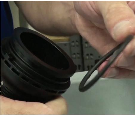
**Paso 11:** Remueva y reemplace el o-ring de la manga de inyección (Parte #: JDI100).
