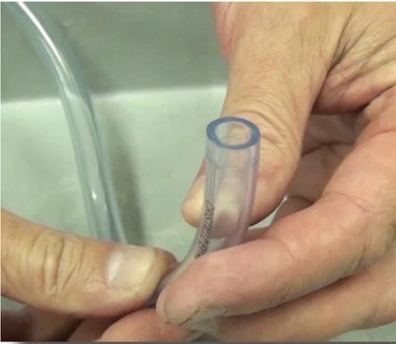
**Paso 25:** Examine la manguera de succión antes de reinstalarla. Si está ensanchada, córtela una pulgada más o menos y vuélvala a instalar. Si la manguera tiene ranuras, agujeros, o se ve vieja, entonces es tiempo de reemplazarla.
