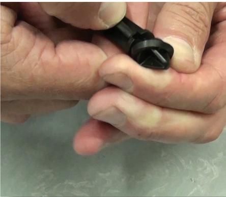
**Paso 19:** coloque el vástago de inyección a un lado y agarre el cuerpo azul. Remueva el sello del émbolo apretándolo y deslizándolo fuera del émbolo.
