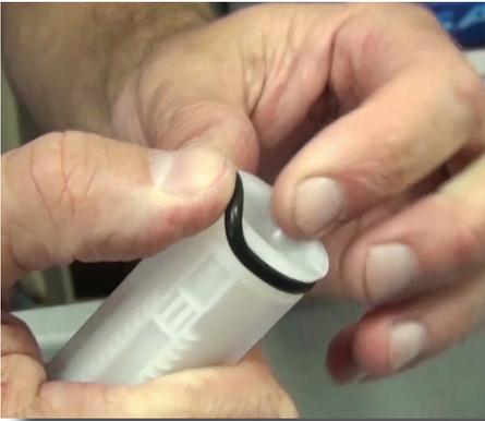
**Paso 10:** Remueva y reemplace el anillo de la barra de inyección (Parte #: JDI120).
