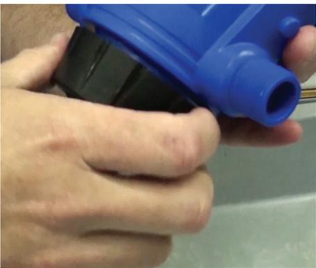
**Paso 2:** Desatornille la tuerca del vástago de inyección.
