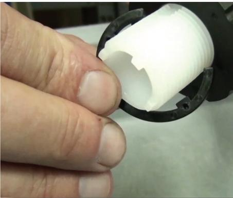
**Paso 7:** Remueva la abrazadera en forma de “C” esparciendo la abertura y deslizándola sobre las roscas.
