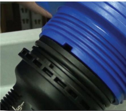
**Paso 21:** Para finalizar, alinee las guías en la parte inferior del cuerpo azul con los dientes en la parte superior del vástago de inyección.
