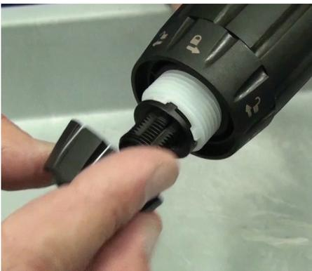
**Paso 18:** Reinstale la tuerca de la válvula cheque.
