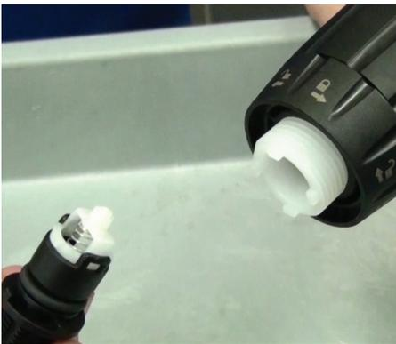
**Paso 17:** Inserte la nueva válvula cheque (Parte #: PJD1115) dentro de la barra blanca.
