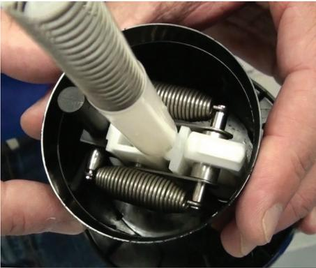
**Paso 4:** Inspeccione el resorte del accionador (Parte #: M009) en la parte inferior. Si falta alguna parte o se encuentra malgastada, replácela.
