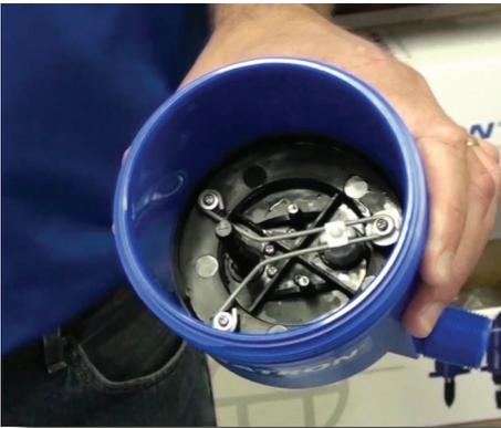
**Paso 2:** Agarre la espoleta de metal y jale el pistón completamente hacia afuera.
