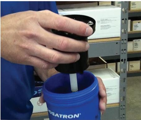
**Paso 13:** Cuidadosamente inserte el ensamble del pistón dentro del cuerpo, empujándolo hasta el fondo.
