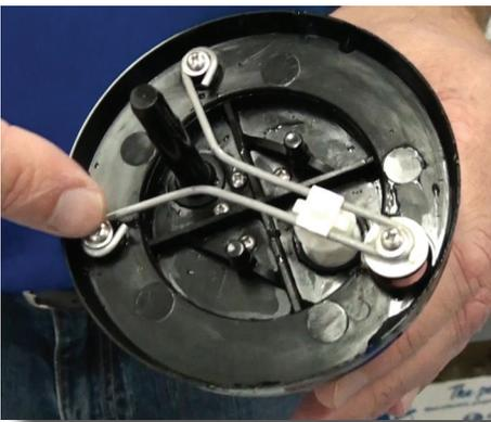
**Paso 3:** Coloque el cuerpo azul a un lado e inspeccione la espoleta (Parte #: MP014) en la parte superior. Si falta alguna parte o se encuentra malgastada, replácela.
