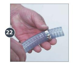
Antes de instalar la manguera de succión, revísela. Si está ensanchada, córtele más o menos media pulgada de la punta y conéctela. Si está agrietada, rígida, o se ve muy desgastada, reemplácela.
