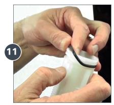
Remueva y reemplace el O-Ring de la Barra de Inyección (Parte #: JDI122).
