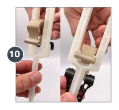
Deslice la otra punta del Resorte Omega dentro del canal en la barra de presión como se indica en la imagen.
