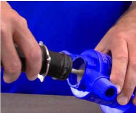
**Paso 23:** Cuidadosamente inserte el ensamble de inyección sobre el émbolo.
