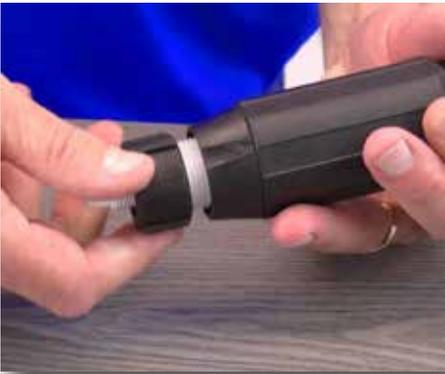
**Paso 4:** Desatornille y remueva la tuerca de la válvula cheque.
