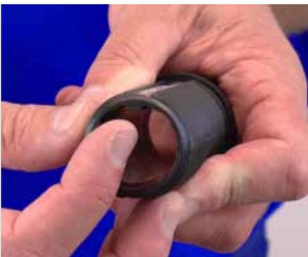
**Paso 12:** Para el re-ensamble, alinee la ranura en la barra blanca con el diente dentro de la parte inferior de la manga negra.
