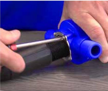
**Paso 25:** Coloque los cuatro tornillos, posicione la escala hacia afuera en el vástago, y apriete los tornillos con la mano.
