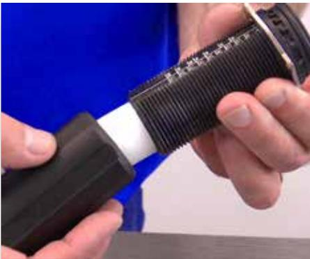
**Paso 8:** Desatornille y remueva la tuerca de ajuste. Ahora remueva el retenedor metálico.
