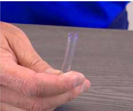
**Paso 26:** Revise la manguera de succión antes de instalarla. Si esta ensanchada córtela una pulgada más o menos y vuélvala a conectar. Si la manguera está rota, muy rígida, o se ve muy usada es tiempo de reemplazarla.
