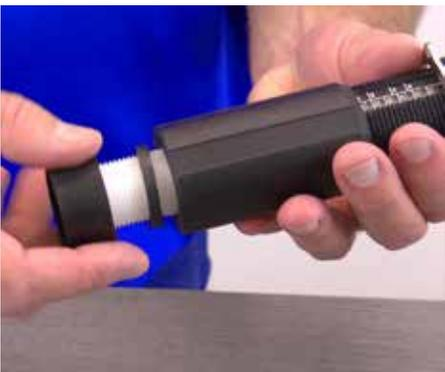
**Paso 6:** Desatornille la tuerca de seguridad.
