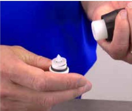
**Paso 5:** Jale la válvula cheque completamente hacia afuera de la barra blanca y deseche la.
