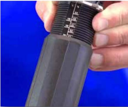
**Paso 16:** Acomode la escala a 1:200 o .5%. Esto le asegurará suficiente rosca para el paso siguiente.
