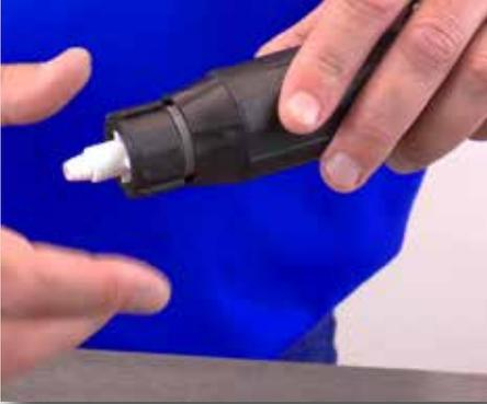
**Paso 20:** Re-instale la tuerca de la válvula cheque. Coloque el vástago a un lado.
