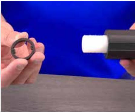
**Paso 17:** Alinee los dientes dentro del anillo antibloqueo con las ranuras en la barra blanca, y deslice el anillo hasta tocar la manga negra.
