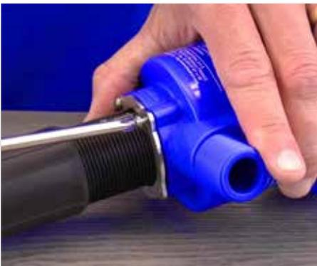
**Paso 2:** Remueva los cuatro tornillos en la base del vástago de inyección.
