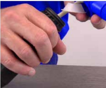
**Paso 3:** Jale el vástago de inyección directamente hacia afuera del cuerpo del inyector. Coloque el cuerpo a un lado.
