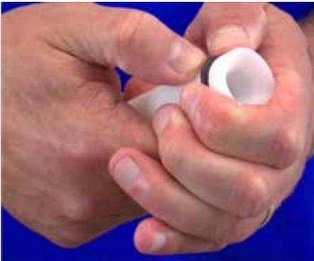
**Paso 10:** Ahora remueva el o-ring de la barra de inyección (Parte #: JDI098) apretándolo y rodándolo hacia afuera de la barra blanca. Instale el nuevo o-ring en la ranura.
