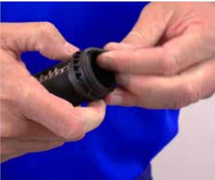
**Paso 11:** Remueva el o-ring de la manga de inyección (Parte #: J024) apretándolo y deslizándolo fuera de la manga. Instale el nuevo o-ring en la ranura.
