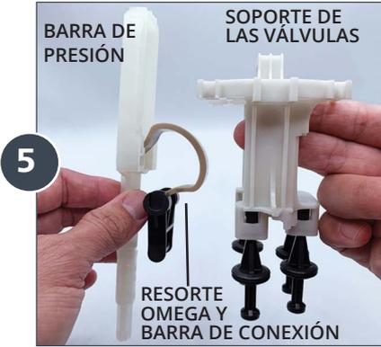
Probablemente saldrá en dos o tres piezas. La primera es el soporte de las válvulas y las otras piezas son la barra de presión, Resorte Omega, y la Barra de Conexión.
