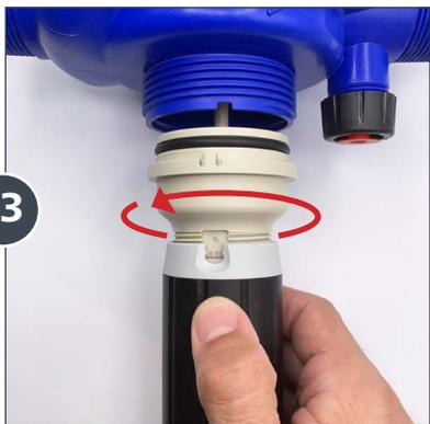
Si la escala de su preferencia no se muestra hacia afuera, afloje y remueva la tuerca del ensamble de inyección.
