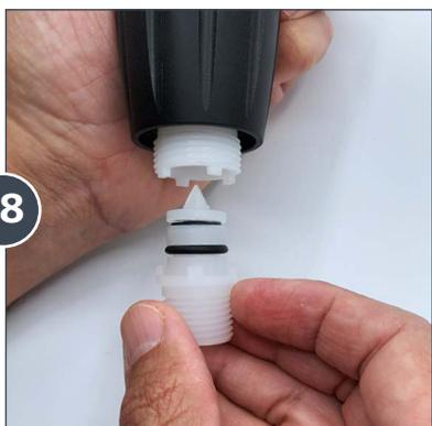
Instale la nueva **Válvula Cheque (Parte #: PJD1215)** dentro del vástago de inyección.
