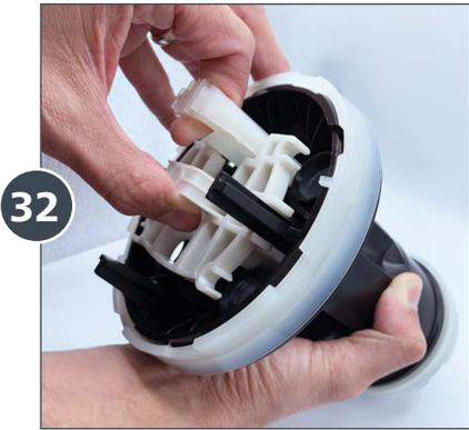
Ahora, evalúe el ensamblaje del pistón jalando con cuidado la barra de presión hacia arriba hasta que escuche un clic, ahora vuelva a colocar las últimas 3 válvulas.
