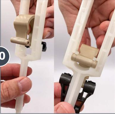
Deslice la otra punta del Resorte Omega dentro del canal en la barra de presión como se indica en la imagen.
