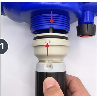
Con cuidado inserte el émbolo dentro del vástago de inyección de manera vertical para evitar que se doble.
