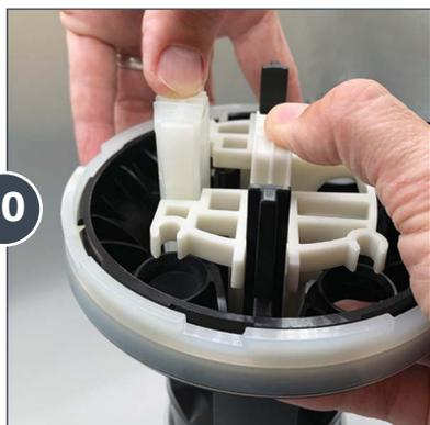
Comience a presionar con cuidado el mecanismo (ambos ensambles) en su lugar, dentro de la cobertura del pistón y vuelva a verificar la alineación de ambas secciones.
