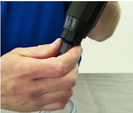
**Paso 2:** Si aún no hay succión, abra la llave del agua. Si el inyector hace clic, desatornille y remueva la tuerca de la manguera de succión.
