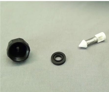
**Paso 6:** Inspeccione el sello (Parte #: J051) y la válvula cheque (Parte #: MPD1122). Si están sucios usted puede enjuagarlos, cepillarlos, y volverlos a instalar. Si ve que hay daños o no recuerda cuando fue la última vez que cambio estas partes, reemplácelas ahora.
