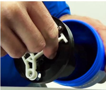
**Paso 3:** Sujete el soporte blanco de la válvula y jale el pistón hasta sacarlo del cuerpo.
