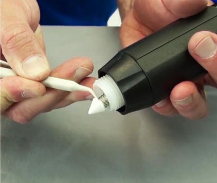
**Paso 5:** Con cuidado saque la válvula cheque fuera del vástago, el uso de un palillo (Parte #: TOOL02) o un destornillador pequeño puede facilitar el proceso.
