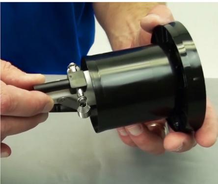
**Paso 15:** Coloque el ensamble del accionador en la cobertura como se muestra en la imagen, y sujételo firmemente.
