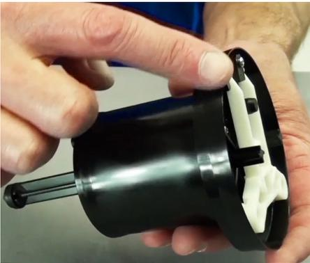
**Paso 7:** Usted puede examinar la cobertura del pistón inspeccionando el estado de las guías superior e inferior. Si están desgastadas o tienen hendiduras profundas, la cobertura del pistón debe ser reemplazada.
