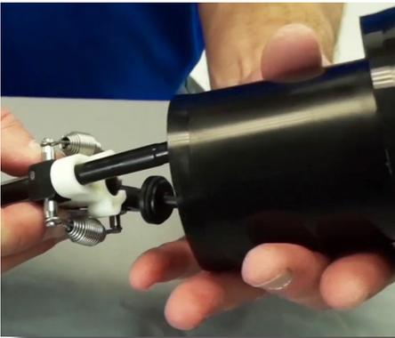
**Paso 13:** Jale el ensamble del accionador hacia afuera y deseche la cobertura del pistón usada.
