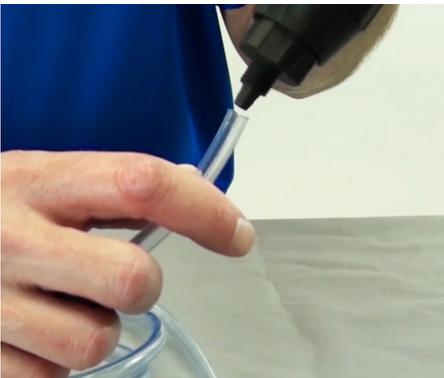
**Paso 5:** Si siente que hay succión, solo corte media pulgada de la punta de la manguera y vuélvala a conectar. Usted puede ver si el líquido comienza a desplazarse hacia arriba en la manguera.
