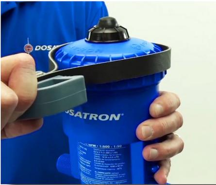
**Paso 1:** Si el inyector no está haciendo clic, use una llave de correa (Parte #: TOOL01) para aflojar la tapa.
