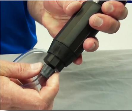
Si su inyector está empujando agua dentro del tanque de concentrado, es hora de examinar la válvula cheque.
