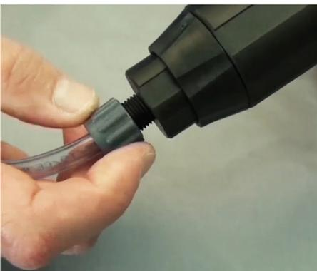
**Paso 12:** Atornille la tuerca de la manguera apretándola con la mano. Esto debe evitar que el agua sea empujada al tanque de concentrado.
