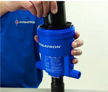
**Paso 8:** También examine el ajuste de la cobertura dentro del cuerpo. Para esto invierta el pistón e introdúzcalo dentro del cuerpo, debe entrar ajustado. Si se siente que entra muy flojo, tanto la cobertura del pistón (Parte #: P421) como el o-ring de la barra de presión (Parte #: J020) deben ser reemplazados.
