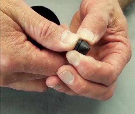
**Paso 11:** Para reemplazar el sello, apriételo y deslícelo hasta sacarlo del émbolo.
