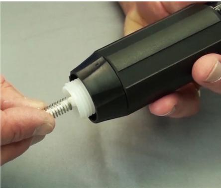
**Paso 7:** Para el re-ensamble, inserte la nueva válvula cheque dentro del vástago, hasta el fondo.
