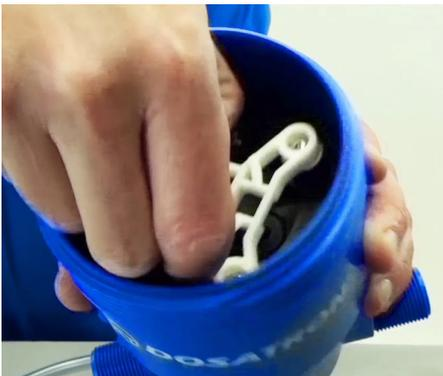
**Paso 9:** Sujete el soporte blanco de la válvula y jale el pistón hasta sacarlo del cuerpo. Colóquelo a un lado.
