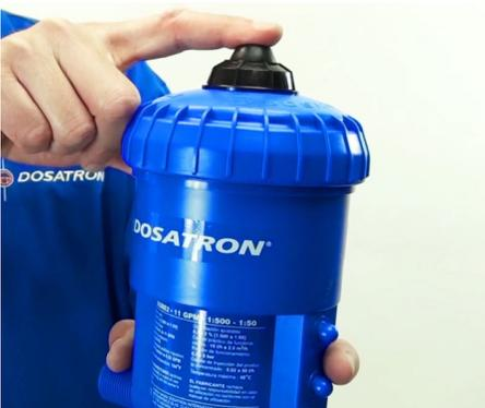
**Paso 6:** Si usted no ve desplazamiento de líquido o no siente que hay succión, cierre la llave del agua. Presione varias veces el botón de purga de aire que se encuentra en la tapa del Dosatron para liberar la presión.
