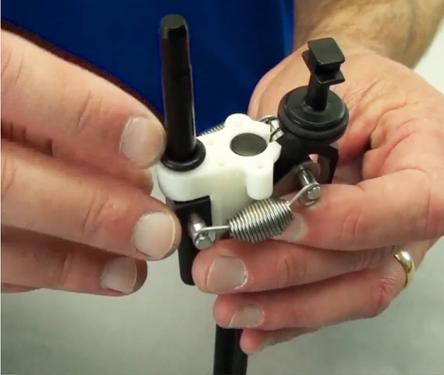
**Paso 14:** Coloque el nuevo o-ring en la barra de presión y empújelo completamente hacia abajo.
