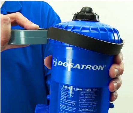
**Paso 7:** Afloje la tapa de la unidad utilizando una llave de correa (Parte #: TOOL01).
