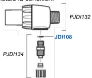
16. Desatornille la tuerca (PDI901) y jale el conector lateral (PDI902) para exponer las partes de la válvula cheque (PJDI161). Jale el ensamble completo fuera del cuerpo de inyección lateral.
