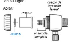
Conecte el ensamble de inyección lateral, con tubos y puertos, de nuevo al cuerpo de la unidad.
