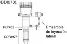
2. Remueva la tuerca dela manguera (PDI748), la tuerca de la válvula cheque (PDI747), tuerca de seguridad (PDI746), anillo de seguridad (PDI751) y tuerca de ajuste (PPDI037).
