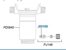
15. Remueva la conexión (PJDI134) de la parte inferior del ensamble de inyección lateral (PJDI132), reemplace el o-ring (JDI108) y reinstale la conexión.
