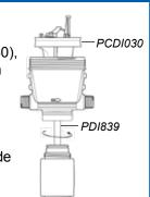
11. Empuje el cilindro (PDI840) hacia arriba y atornille la tuerca (PDI841), asegurándose que los puertos de inyección lateral y del cuerpo de la unidad, están alineados.
