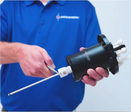
**Paso 6:** Si usted removió el émbolo en el paso anterior, vuelva a colocar el émbolo atornillándolo en la dirección de las manecillas del reloj.
