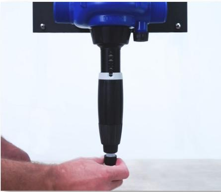
**Paso 7:** Desatornille la tuerca de la manguera de succión y remueva la manguera de succión. Colóquelas a un lado.
