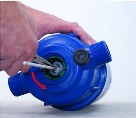
**Paso 12:** Sujete el émbolo por la parte superior con el alicate y girelo cuidadosamente un cuarto de vuelta, en la dirección opuesta a las manecillas del reloj hasta sacarlo, deséchelo.
