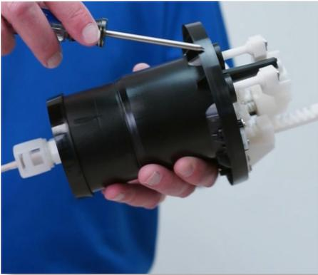
**Paso 5:** Ahora revise las guías superior e inferior en la cobertura del pistón. Si están desgastadas o tienen rasguños profundos, la cobertura del pistón (Parte #: 8PC002), debe ser reemplazada.
