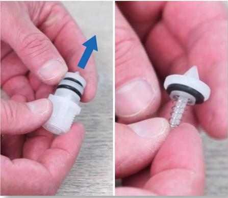
**Paso 4:** Para revisar la válvula cheque, con cuidado levante el cono del retenedor. Revise la parte inferior del cono. Cuidadosamente levante el retenedor del sello, y revise que no haya nada sujetado o atascado.
