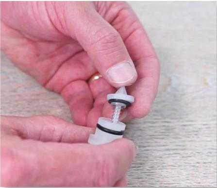
**Paso 5:** Para re-ensamblar, coloque la nueva válvula cheque encima de la lengüeta.
