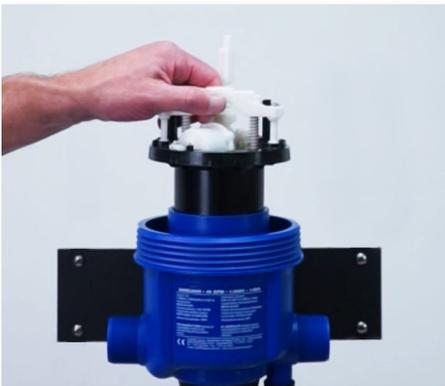
**Paso 3:** Sujete el puente plástico blanco en la parte superior del pistón y jálalo hacia afuera.
