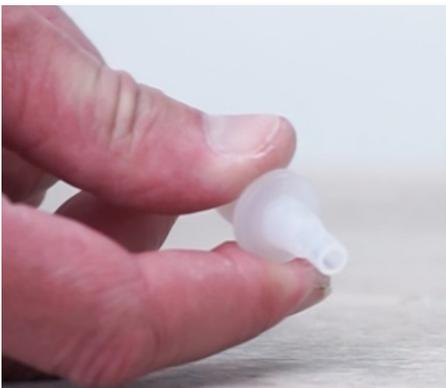
**Paso 3:** Deslice el casquillo hacia atrás y corte media pulgada de la punta de la manguera. Vuelva a empujar el casquillo hacia la punta.
