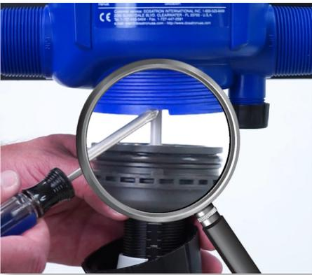
**Paso 14:** Alinee las muescas en la parte inferior del cuerpo azul con los dos dientes en la parte superior del vástago de inyección. Empuje las partes juntas, y apriete la tuerca del vástago con la mano.
