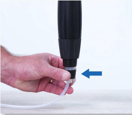
Si su Dosatron está empujando agua dentro del tanque de concentrado, es hora de examinar la válvula cheque.
