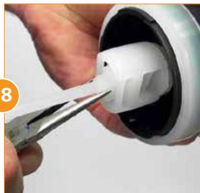
Reinstale el **Émbolo con Empaque/Sello (Parte #: PJD1138)** en la parte inferior de la cobertura del pistón. Usando las pinzas de punta delgada, dele vuelta en la dirección de las manecillas del reloj para asegurarlo.
