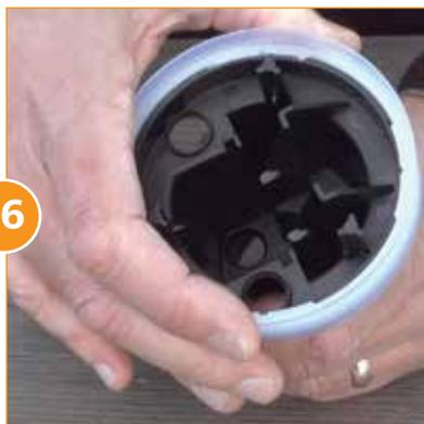
Alinee el diente en el anillo con el agujero en la cobertura del pistón. Presione hacia abajo, y dele un cuarto de vuelta en la dirección de las manecillas del reloj. Si se dificulta darle la vuelta al anillo o este se levanta fácilmente, sáquelo, y realínéelo.
