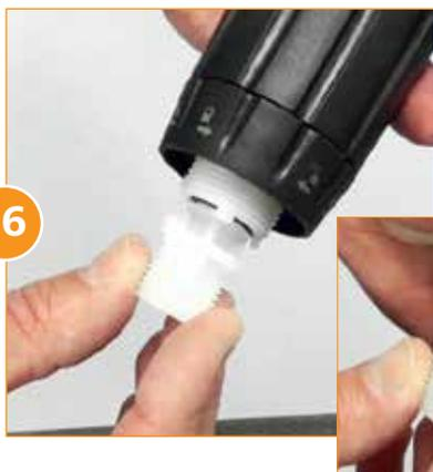
Instale la nueva **Válvula Cheque (Parte #: PJD1140)**, en el vástago de inyección. Asegurese que está en la misma posición que se enseña en la imagen.
