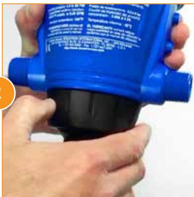
Desatornille la tuerca del vástago de inyección.
