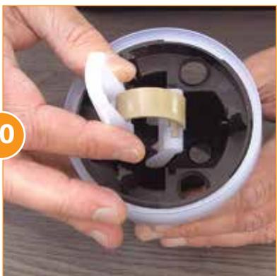
En el alineamiento del ensamble de la barra de presión, la parte curvada debe apuntar hacia adentro, y la barra de presión entra en el agujero individual. Acá es donde encaja la barra de conexión en el pistón.
