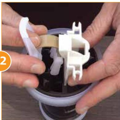
Ahora para insertar el soporte de la válvula y la barra de presión en la cobertura del pistón, use su dedo índice para empujar el resorte. Esto ubicará todo en su lugar, y usted escuchará un clic. Si las partes no encajan justas, levante ambos ensambles y trate de nuevo.
