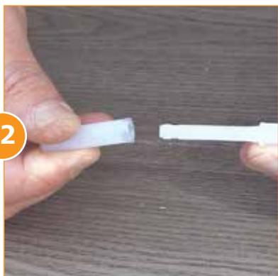
Reemplace el **Empaque/Sello de la Barra de Presión (Parte #: PDI648)**. Dele un giro en contra de las manecillas del reloj para removerlo. Cuidadosamente coloque el nuevo empaque/sello sobre la barra de presión, empújelo hasta el final y dele un cuarto de vuelta en la dirección de las manecillas del reloj.
