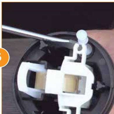
Para remover el motor y el ensamble soporte de la válvula de la cobertura del pistón, va a necesitar un destornillador de cabeza plana. Utilice el destornillador para remover las válvulas superiores. Las válvulas parecen puntillas de golf y saldrán fácilmente de la cobertura del pistón. Colóquelas a un lado.
