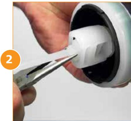
Sujete el émbolo con unas pinzas de punta delgada, cerca de la parte superior, y dele vuelta en contra de las manecillas del reloj para removerlo.
