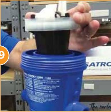
Cuidadosamente coloque el pistón de nuevo en el cuerpo del inyector y atornille la campana.
