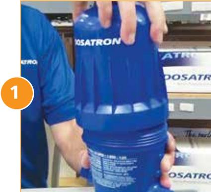
Comience removiendo el pistón de su inyector Dosatron. Desatornille y remueva la campana (tal vez necesite usar una llave de correa), ahora jale el pistón fuera del cuerpo. Coloque la campana y el cuerpo a un lado.
