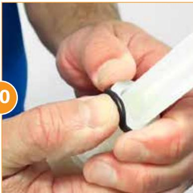
Remueva y reemplace el **O-Ring de la Barra de Inyección (Parte #: JDI120)**.
