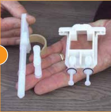
Ahora tiene dos sub-ensambles – la barra de presión en la izquierda y el marco soporte de la válvula en la derecha.
