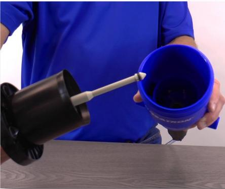
**Paso 7:** Sujete el soporte blanco de la válvula y jale el pistón hasta sacarlo del cuerpo. Colóquelo a un lado.
