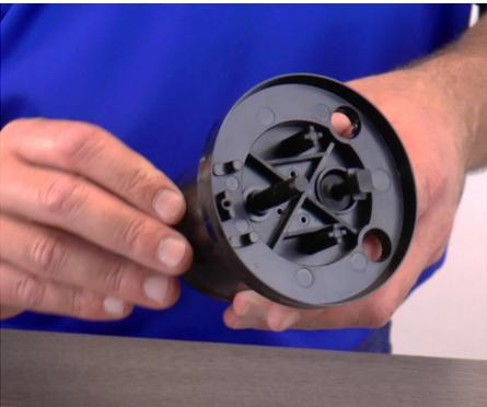
**Paso 14:** Coloque el ensamble del accionador en la cobertura como se muestra en la imagen, y sujételo firmemente.
