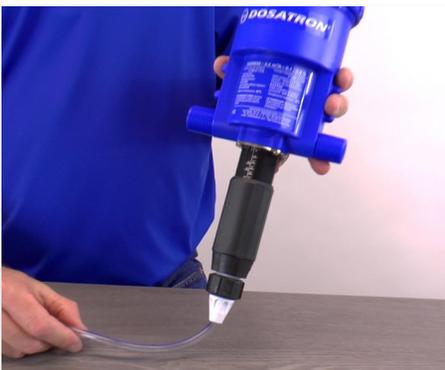
**Paso 9:** Deslice la tuerca de la manguera de succión por la manguera. Sujete la manguera a la lengüeta y atornille la tuerca de la manguera apretándola con la mano.
