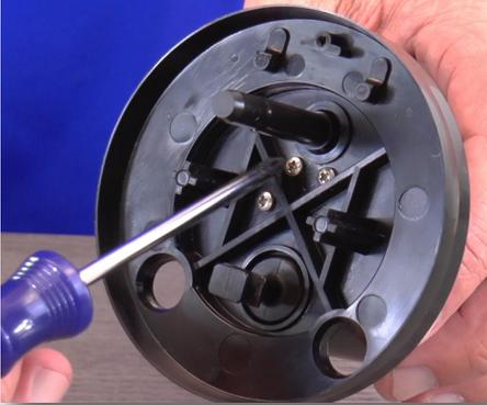
**Paso 11:** Ahora, remueva los cuatro tornillos del centro de la cobertura del pistón para soltar el ensamble del accionador.
