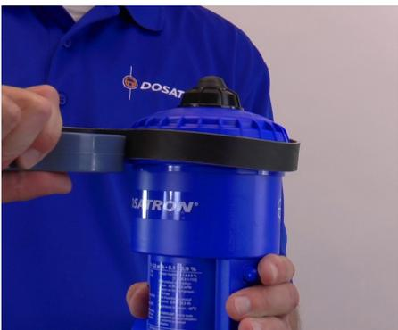
**Paso 6:** Afloje la tapa de la unidad utilizando una llave de correa (Parte #: TOOL01), y colóquela a un lado.
