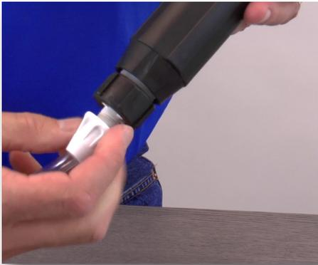
**Paso 1:** Es hora de examinar la válvula cheque. Para examinar la válvula cheque, remueva la tuerca de la manguera de succión y la manguera.
