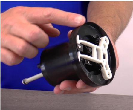
**Paso 6:** Examine la cobertura del pistón inspeccionando el estado de las guías superior e inferior. Si están desgastadas o tienen hendiduras profundas, la cobertura del pistón (Parte #: P421) y el o-ring (Parte #: J020) del la barra de presión deben ser reemplazados.
