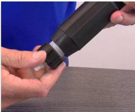
**Paso 2:** Desatornille y remueva la tuerca de la válvula cheque.
