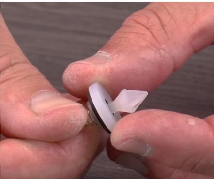
**Paso 5:** Para revisar la válvula cheque, cuidadosamente levante el cono del retenedor. Revise la parte inferior del cono.
