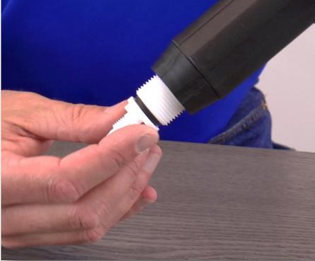
**Paso 8:** Introdúzcala en el vástago como se indica en la imagen. Atornille la tuerca de la válvula cheque apretando con la mano.
