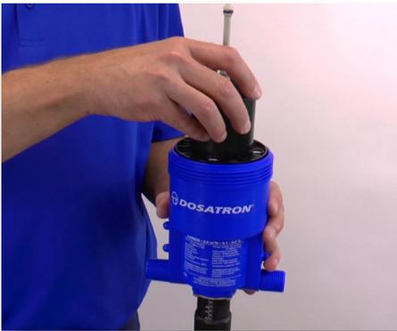
**Paso 7:** También examine el ajuste de la cobertura dentro del cuerpo. Para esto invierta el pistón e introdúzcalo dentro del cuerpo, debe entrar ajustado. Si se siente que entra muy flojo, tanto la cobertura del pistón (Parte #: P421) como el o-ring de la barra de presión (Parte #: J020) deben ser reemplazados.
