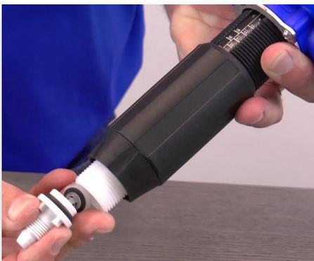
**Paso 3:** Sujete la lengüeta blanca y jale la válvula cheque directamente hacia afuera del vástago. Esta sale normalmente en dos partes.
