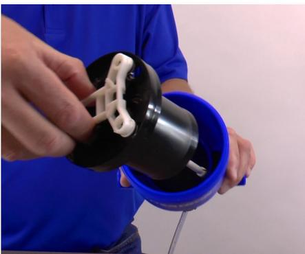
**Paso 3:** Sujete el soporte blanco de la válvula y jale el pistón hasta sacarlo del cuerpo.
