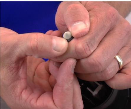
**Paso 9:** Para reemplazar el sello, apriételo y deslícelo hasta sacarlo del émbolo. Instale el nuevo sello en la ranura.
