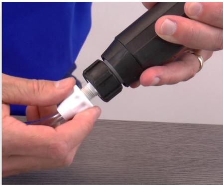
**Paso 2:** Si el inyector aun no succiona concentrado, desatornille la tuerca de la manguera de succión y remueva la manguera.
