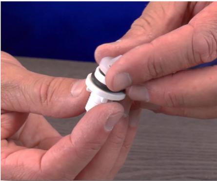
**Paso 7:** Para el re-ensamble, coloque la válvula cheque (Parte #: PJD1026) en la parte superior de la lengüeta.
