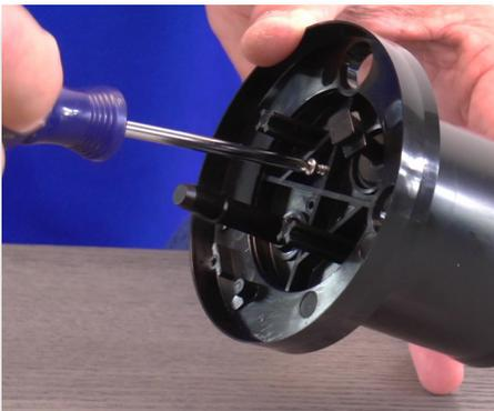
**Paso 15:** Ahora vuelva a colocar los cuatro tornillos y apriételos en orden uno en frente del otro para que queden balanceados.
