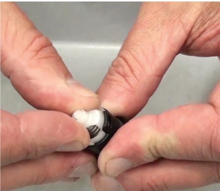
**Paso 11:** Alinee la guía y dele 1/4 de vuelta en la dirección de las manecillas del reloj. Jale la guía blanca hacia arriba para asegurarse que está fija en posición.
