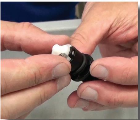
**Paso 6:** Para cambiar las partes de la válvula cheque, sostenga la lengüeta y dele un giro a la guía superior blanca (Parte #: PDI739) 1/4 de vuelta en contra de las manecillas del reloj para removerla.
