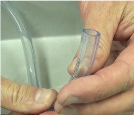
**Paso 19:** Examine la manguera de succión antes de instalarla. Si está ensanchada, córtela una pulgada más o menos y vuélvala a instalar.
