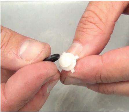
**Paso 8:** Instale las partes nuevas colocando el o-ring (Parte #: JDI105) en el cono.
