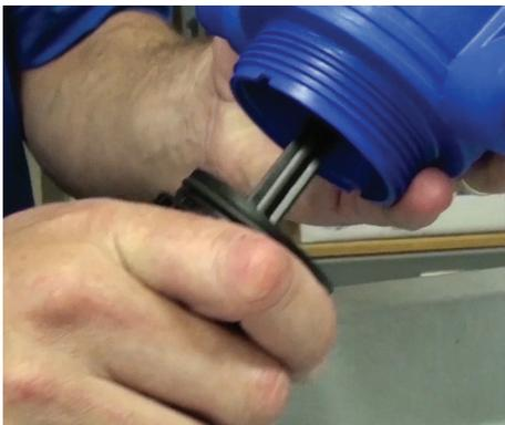
**Paso 3:** Jale el vástago hacia abajo para desprenderlo del cuerpo de la unidad. Coloque la tuerca y el cuerpo a un lado.
