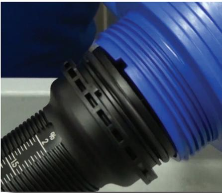
**Paso 16:** Para finalizar, alinee las guías en la parte inferior del cuerpo azul con los dientes en la parte superior del vástago de inyección.
