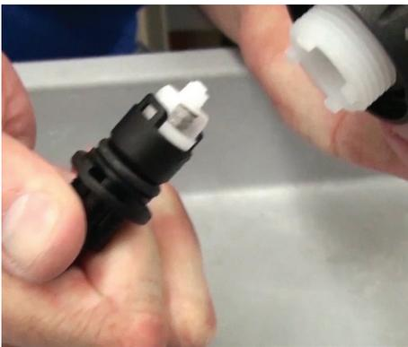
**Paso 5:** Agarre la lengüeta y jale la válvula cheque completamente hacia afuera. Coloque el vástago a un lado.
