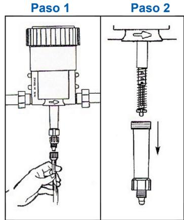
3. Desatornille y remueva la tapa del vástago. Reemplace el **Sello Inferior (J003)**. Remueva el pasador (M005) y reemplace el **Resorte (M003)**. Mueva el pistón hacia arriba y hacia abajo para desalojar y reemplazar el **Sello Superior (J002)**. Asegúrese que la parte elevada del sello apunta hacia arriba.
