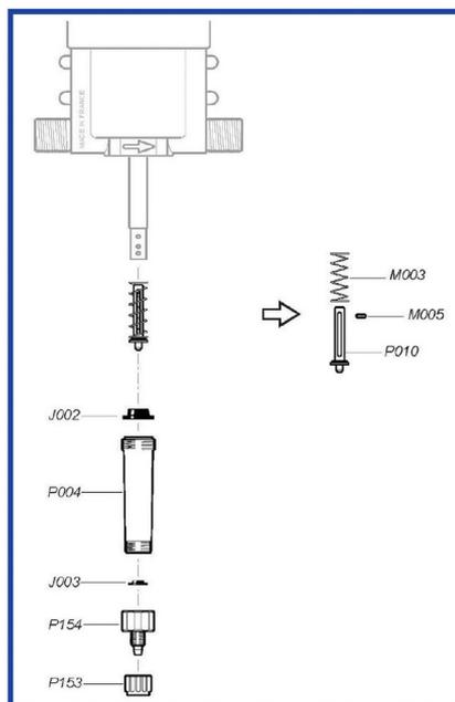
4. Vuelva a colocar el ensamble del vástago de inyección apretando solo con la mano.
