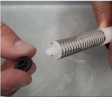
**Paso 1:** Inspeccione el sello inferior (Parte #: J003), válvula de corredera (Parte #: P010), y el resorte (Parte #: M003). Si están desgastados, dañados, deformados, o rotos, remplace las partes.
