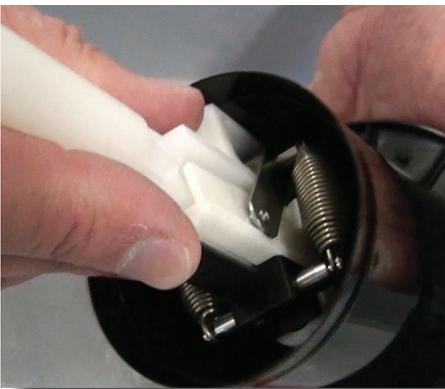
**Paso 23:** Alinee la barra de presión y la válvula de entrada dentro de la cubierta del pistón y deslice el accionador completamente hacia adentro.
