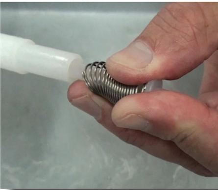
**Paso 4:** Instale la nueva válvula de corredera y el resorte a la barra del émbolo. Para hacerlo, deslice el nuevo resorte sobre la parte superior de la válvula de corredera y sosténgalo firmemente.
