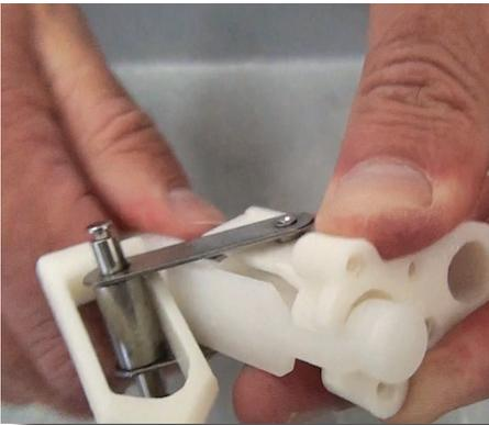
**Paso 20:** Agarre el accionador e instale el nuevo émbolo deslizándolo dentro del accionador y jalándolo hasta que encaje. Asegúrese que la cabeza del émbolo está a ras.
