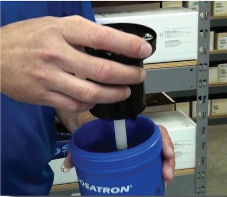
**Paso 10:** Inserte el ensamble del pistón en el cuerpo de la unidad y empujelo completamente hasta el fondo.
