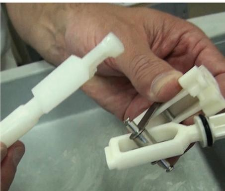
**Paso 15:** Remueva la barra del émbolo (Parte #: P009) levantándola y sacándola cuidadosamente. Coloque el accionador (Parte #: MP001) a un lado.
