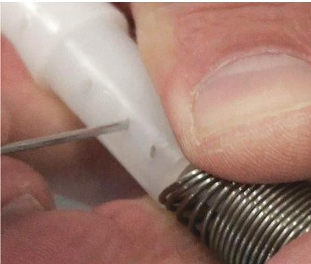
**Paso 17:** Ahora, empuje la espiga metálica (Parte #: M005) hacia afuera, utilizando el gancho sujetapapeles. Esto le ayuda a remover el resorte de la válvula de corredera.
