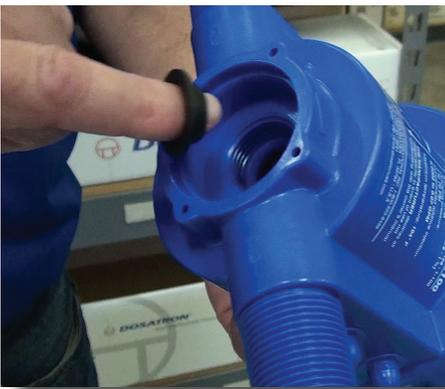
**Paso 6:** Para el re-ensamble, coloque el sello superior con la parte central elevada en dirección hacia arriba dentro del cuerpo de la unidad.
