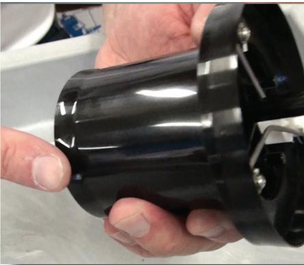
**Paso 5:** Para examinar la cubierta del pistón, remueva el pistón y revise las guías superior e inferior en la cubierta. Si están desgastadas o tienen ralladuras, la cubierta del pistón debe ser remplazada.
