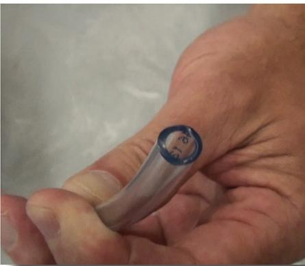
**Paso 12:** Un último detalle. Inspeccione la punta de la manguera de succión. Si está ensanchada, córtela una pulgada más o menos y reinstálela. O si la manguera está agrietada, tiene agujeros, está demasiado rígida, o se ve muy vieja, replácela.
