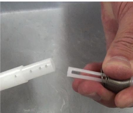
**Paso 18:** Para reinstalar la válvula de corredera en la nueva barra del émbolo, deslice el resorte sobre la válvula de corredera, empuje hasta el fondo y sujete firmemente.
