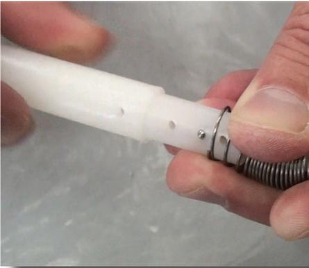
**Paso 19:** Inserte el émbolo y reinstale la espiga metálica. El agujero del centro es la configuración 1:128. Si usted necesita 1:200, instale la espiga en el agujero superior; si usted necesita 1:100, instale la espiga en el agujero inferior. Asegúrese que la espiga está a nivel con la barra para evitar que el resorte se atasque.
