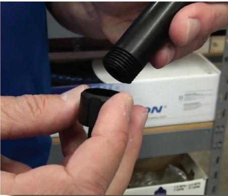
**Paso 8:** Inserte el sello inferior, con la elevación hacia arriba, dentro de la tapa negra y atorníllela al vástago, apretando con la mano.
