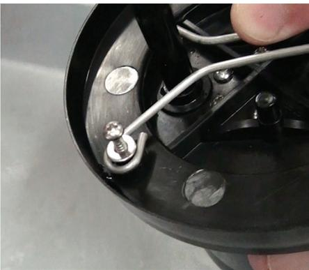
**Paso 26:** Reinstale el resorte de la espoleta, luego coloque las arandelas y los tornillos, no apriete demasiado.
