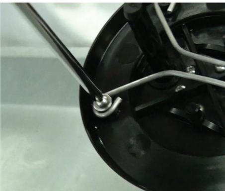
**Paso 9:** Para cambiar la barra del émbolo, use un destornillador Phillips #1 y remueva los dos tornillos y arandelas de la espoleta.
