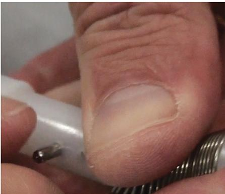
**Paso 3:** Con el punzón, empuje la espiga de metal (Parte #: M005) hacia afuera.
