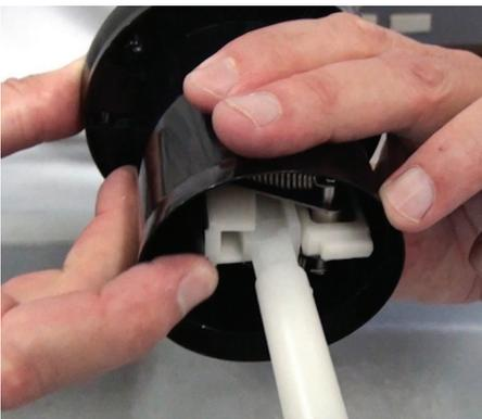
**Paso 27:** Examine el pistón empujando por la parte superior y luego por la parte inferior de la barra de presión. Debe hacer clic las dos veces.
