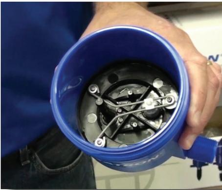
**Paso 2:** Agarre la espoleta de metal y jale el pistón completamente hacia afuera. Coloque el pistón a un lado.
