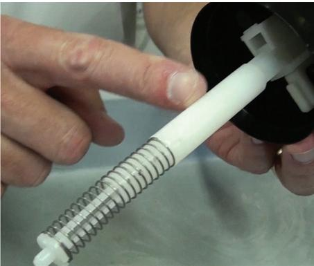
**Paso 8:** Ahora, agarre el pistón e inspeccione el émbolo (Parte #: P009) y la válvula de corredera (Parte #: P010). El émbolo se desplaza dentro de sello superior para crear succión. Si existe acumulación de depósitos o hay ralladuras, esto puede interferir con la cantidad de succión. Si el émbolo tiene acumulaciones, solo sumerja el ensamble del pistón en una solución de Medicator Rx (Parte #: CLEANSER-LS) de 24 a 48 horas. Si el émbolo tiene ralladuras, debe ser reemplazado.
