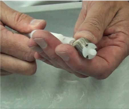
**Paso 16:** Para remover la válvula de corredera de la barra del émbolo, necesitará un gancho sujetapapeles grande o un punzón. Empuje el resorte hacia abajo y sujete firmemente.
