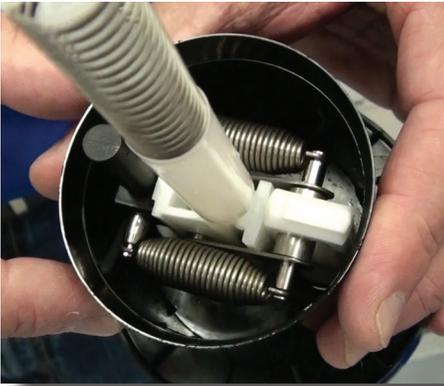
**Paso 4:** Revise el resorte del accionador (Parte #: M009) en la parte inferior. Si ve que hace falta alguna pieza, replácela.
