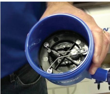
**Paso 2:** Agarre la espoleta de metal y jale el pistón completamente hacia afuera. Coloque el cuerpo azul a un lado.
