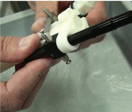
**Paso 14:** Remueva la barra de presión (Parte #: P008) deslizándola hacia afuera.
