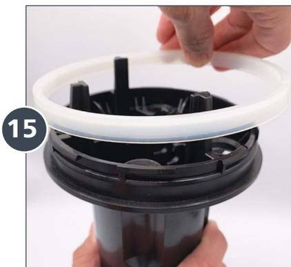
Tome el **Anillo Superior (PDI1093)** del nuevo kit, y deslícelo sobre la cobertura del pistón con la abertura en forma de **V** hacia abajo y el borde plano hacia arriba.
