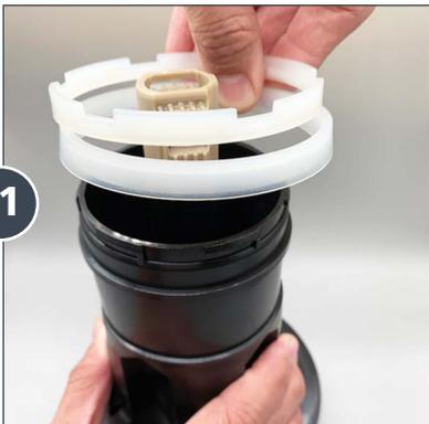
Deslice el Anillo de Seguridad y el Anillo Inferior hacia arriba y fuera de la cobertura del pistón.
