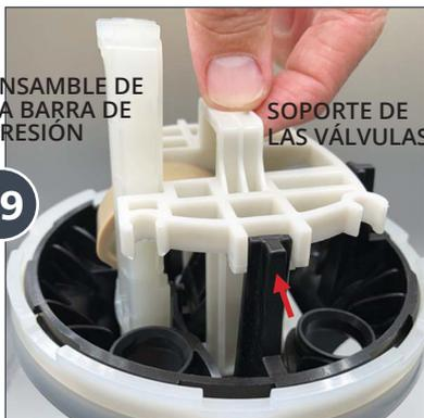
Alinee el Soporte de las Válvulas junto al Ensamble de la Barra de Presión y asegúrese de que el soporte se alinea con las barras negras en la cobertura del pistón y las válvulas inferiores entran en los 4 orificios centrales.
