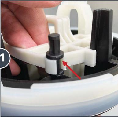
Encaje una de las Válvulas Superiores en el Soporte de las Válvulas.
