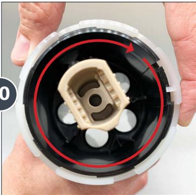
Gire el Anillo de Seguridad más o menos 1/2 pulgada en la dirección de las manecillas del reloj para desbloquearlo, asegúrese de que el Diente blanco se deslice por encima de la Palanca negra.
