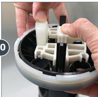
Comience a presionar con cuidado el mecanismo (ambos ensamblajes) en su lugar, dentro de la cobertura del pistón y vuelva a verificar la alineación de ambas secciones.
